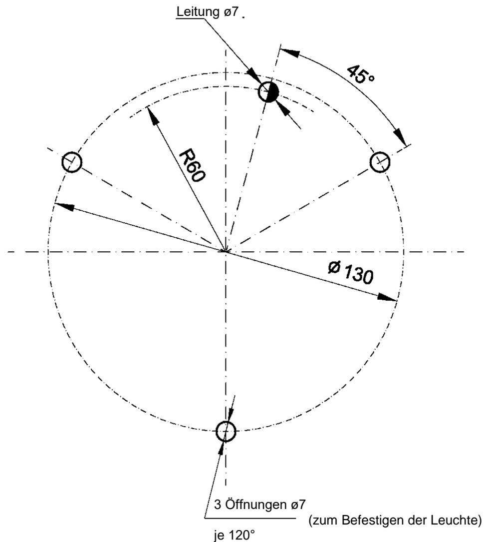
Bild 2 - Anordnung der Bohröffnungen (Ansicht Leuchtenseite)
